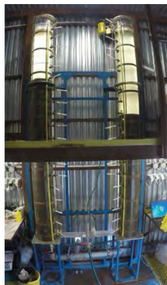
Obr. 1. Sedimentační kolony – l = 3 m, vzdálenost odběrů 0,15 m, D = 150 mm
