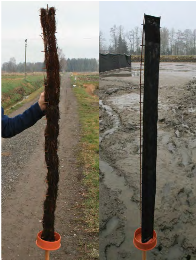
Obr. 3. Odběrové proužky substrátu (vřesovec: vlevo a geotextilie: vpravo) upevněné na železné (kari) síti připevněné na dřevěnou násadu na zakotvení do dna rybníku (autor M. Bláha)
