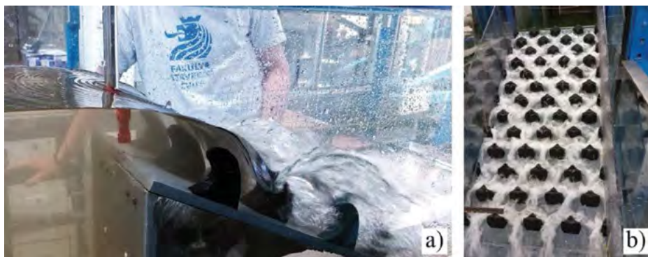
Obr. 4. Příklady účinnosti navržených rozražečů: a) model 1:25 ve zkušebním žlabu šířky 25 cm, b) model 1:16 ve zkušebním žlabu šířky 1 m
