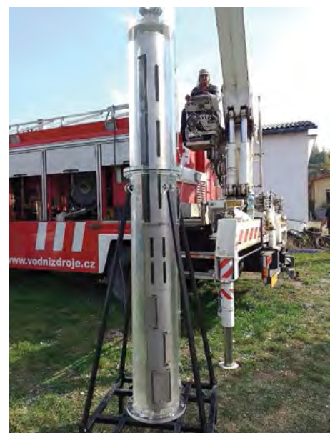
Obr. 2. Ultrazvuková sonda při zátěžovém testu
