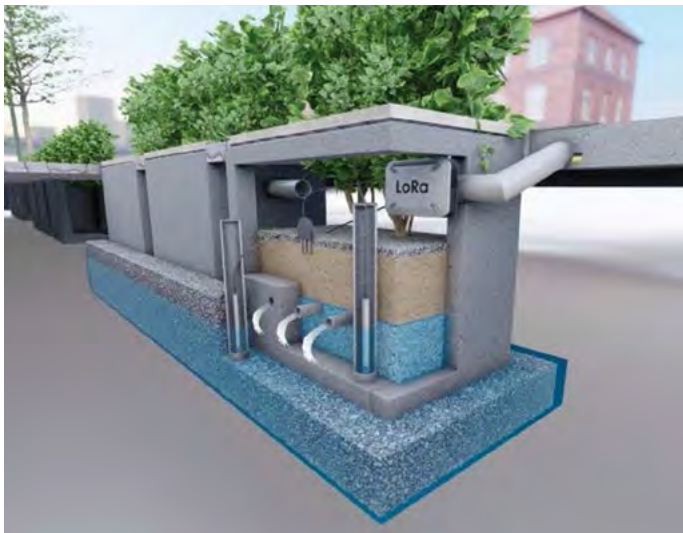
Obr. 6. Výsadbový truhlík v Andongu je součástí „zelené přehrady“ (z prezentace Kyung-Ho Kwona)
