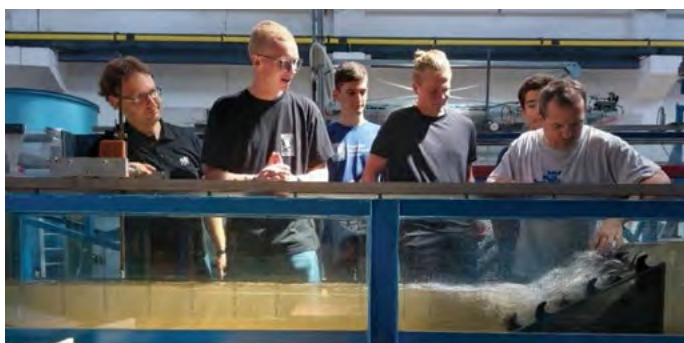
Obr. 1. Středoškolská studenti při testování svých rozražečů ve zkušební žlabu ve Vodohospodářském experimentálním centru Fakulty stavební ČVUT v Praze
