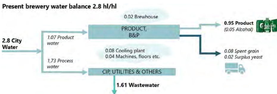
Obr. 2a. Bilance spotřeby vody do vybudování nové recyklační úpravy vody. (City Water – voda z veřejného vodovodu, Product water – voda pro výrobu piva, Brewhouse – varna, Product, B&P – produkt – pivo a nápoje, Cooling Plant – chladicí linka, Machines, floors etc. – stroje, podlahy atd., Product – pivo, Spent grain – použité mláto, Surplus yeast – přebytečné kvasnice; Process water – provozní voda, CIP, Utilities & others – čištění potrubi a technologických zařízení, úklid a další, Wastewater – odpadní voda do veřejné kanalizace
