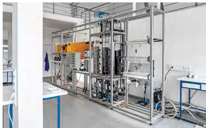
Poloprovodní model úpravy vody s dvoustupňovou separací suspenze a adsorpcí na GAU
