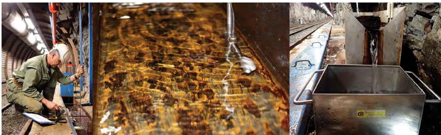
Obr. 4. Ukázka úředního měření průtoku metodou rychlostního pole a metodou konečného objemu
