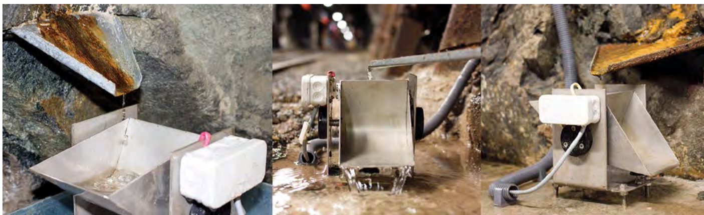
Obr. 2. Ukázka měření průtoku člunkovými průtokoměry
