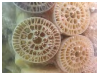
Obr. 2. Nosiče biomasy PAQ 800+
