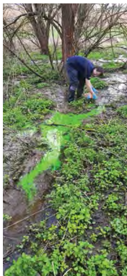
Obr. 3. První injektáž stopovače do Bubovického potoka (vlevo). Automatický odběrák vzorků ve vodárně Srbsko (vpravo)
