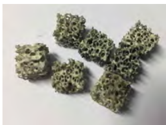
Obr. 1. Heterogenní katalyzátor nanesený laserovou ablací na porézní strukturu
