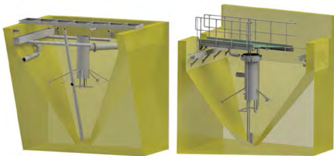
Obr. 2. Dosazovací nádrž čtvercová – ukázka z možných provedení
