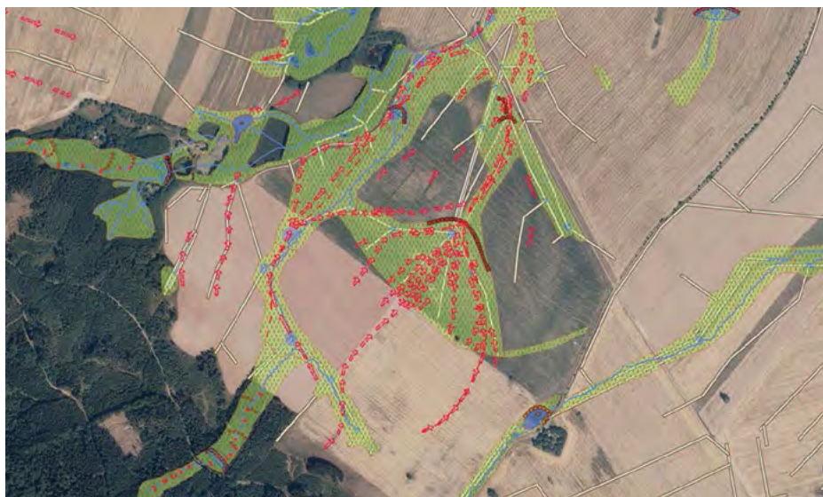
Obr. 3. Návrh řešení údolnic, asanace drah soustředěného odtoku a erozních rýh. Bílé linie jsou hlavníky. Problematický je tvar půdních bloků z hlediska mechanizačního obhospodářování. Křenice 2020. Foto: Živá krajina
