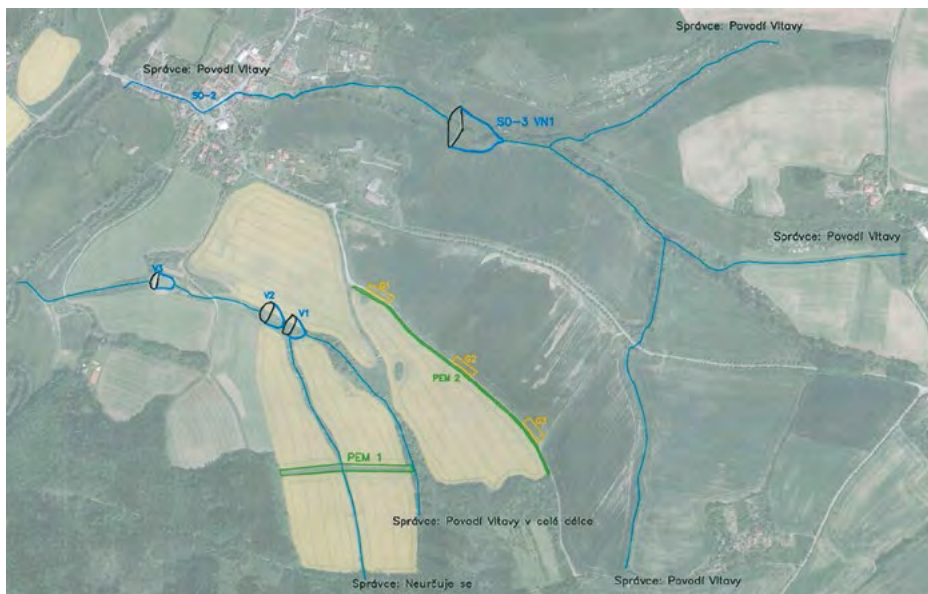
Obr. 7. Příklad realizace komplexní pozemkové úpravy v dílčím povodí. Soustava třech malých vodních nádrží (v1, v2 a v3) postavené vlastníky nově vytvořených pozemků, malé vodní nádrže So – 3VN 1 postavené Státním pozemkovým úřadem na toku, který je ve správě Povodí Berounky a dále protierozní meze zasakovacího travního pásu a třech zasakovacích podzemních kontejnerů, také investice SPÚ. A půdní bloky orné půd využívá příjemce dotací stále stejným způsobem (Předenice, Plzeň jih, [6]). Foto: Mazín
